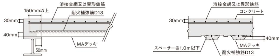
\*4 ひび割れ拡大防止筋は記載の鉄筋量以上とし、φ6-75X75あるいはD10-200X200も適合する。
